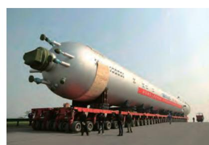
国机重装所属二重装备制造的世界最重（2400吨）沸腾床渣油锻焊加氢反应器在国机重装镇江基地发运
