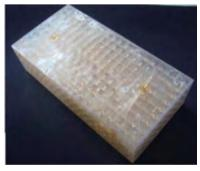
图5 型壳脱蜡后的SLA树脂模试样(内塌陷) 图6 直接在蒸汽脱蜡釜中加热的SLA
