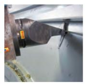
图5 加工斜槽刀具
