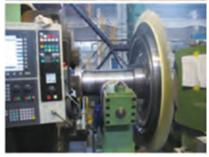
图5 F级燃气轮机转子叶顶磨削
