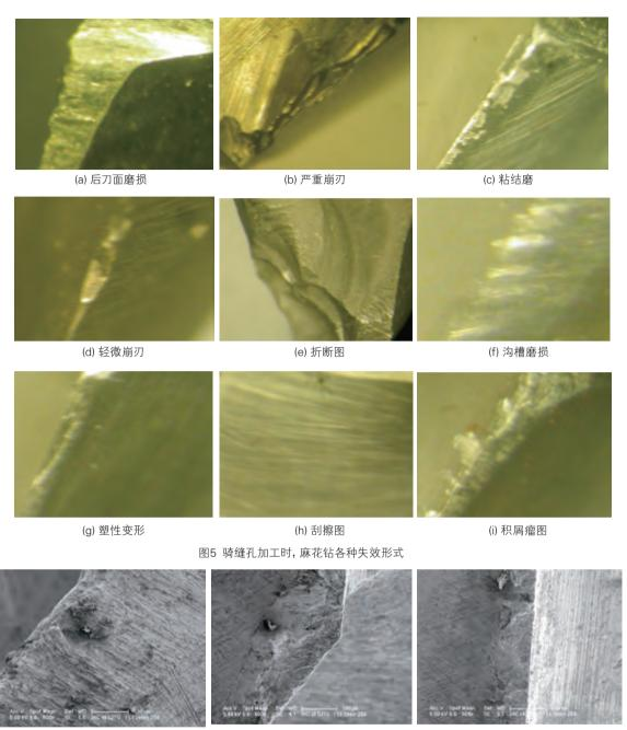
图6 M42麻花钻刀具微观磨损形貌 (转速150 r/min, 进给量0.06 mm/r)
