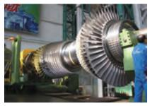
图2 F级燃气轮机转子装夹图
