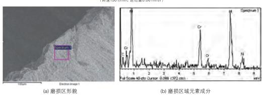
图7 M42麻花钻磨损区域的元素成分 (转速150 r/min, 进给量0.06 mm/r)
