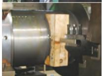
图4 F级燃气轮机转子车削加工
