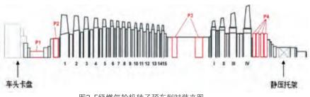
图3 F级燃气轮机转子预车削时装夹图
