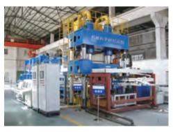
超高强钢热冲压成套技术及自动化中试线已建成国内首条具有完全自主知识产权的基于中央控制的28万件产能自动化中试线,自主开发制造的高速高精坐标机械手可实现2件/分钟的生产节拍,在线检具可实现实时检测零部件精度并进行在线分检。生产线厂房面积1000平米,拥有10吨的桁吊以及完备的原料贮存、生产作业、加工检测、表面处理等功能区域,可以完成设计开发、生产制造、模具加工、实验检测、喷砂处理、质量保障、生产储备等全生产环节。已为北汽福田批量生产供应200台迷迪新能源车型的超高强钢车门防撞梁,并且为一汽等自主品牌开发制造电机支架、前保险杠等结构件,产品
