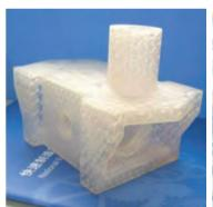
图1 某铸件的SLA树脂模
